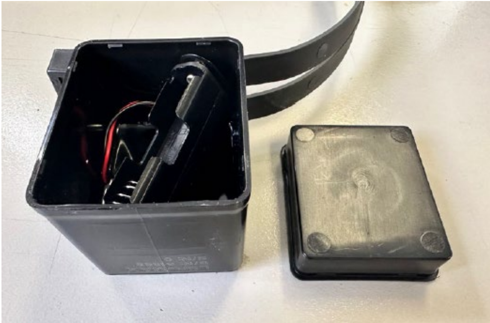
Figur 1: Dekselet må fjernes for å sette inn 2 x 1,5 V AA-batterier.
