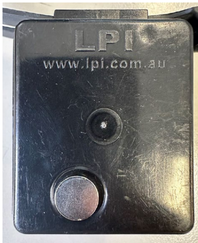
Figur 4: LSR-MAX utløses fra lavstrømstilstand ved hjelp av en magnet plassert på det innrykkede stedet.
